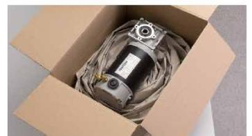
Der über den SpeedMan® Classic gespendete Füllpapierschlauch wird über die Wheel-Einheit zu einer praktischen Papierpolsterschnecke verarbeitet.
