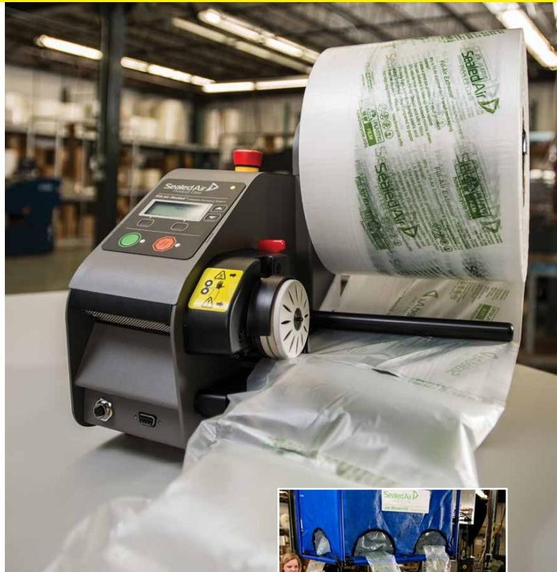
Verpacken nach Bedarf: Verschiedene Zufuhroptionen steigern die Verpackungseffizienz. Der Auto-Nachfüll-Sensor sichert die gleichmäßige Versorgung mit Material.
